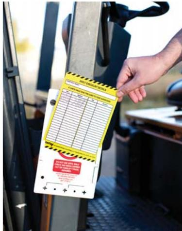
Die durchgeführte Prüfung wird mit der Unterschrift des Bediener und dem Datum auf dem Forklifttag-Einsteckschild vermerkt. Wenn der Gabelstapler sicher verwendet werden kann, wird das Forklifttag-Einsteckschild in den Forklifttag-Halter gesteckt, sodass die Details der täglichen Prüfungen und der letzte Prüftermin sofort deutlich sichtbar sind.
