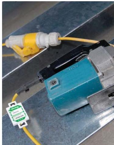
Das Gerät wird von einer qualifizierten Person geprüft. Wenn das Gerät sicher verwendet werden kann, wird der nächste Prüf- oder Inspektionstermin auf dem Microtag-Einsteckschild vermerkt, und das Einsteckschild wird in den Halter gesteckt.
