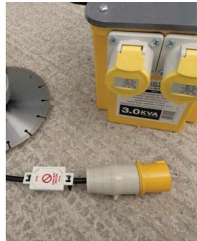
Wenn ein Gerät die Prüfung oder Inspektion nicht besteht, wird das Microtag-Einsteckschild aus dem Halter entfernt, der daraufhin sofort wieder das Verbotssymbol mit dem Hinweis „Dieses Gerät nicht verwenden“ anzeigt.
