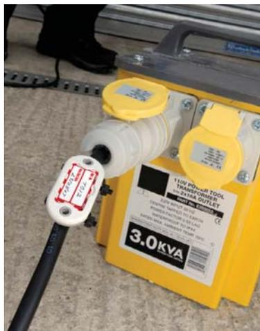
Das Gerät wird von einer qualifizierten Person geprüft. Wenn das Gerät sicher verwendet werden kann, wird der nächste Prüf- oder Inspektionstermin auf dem Nanotag-Einsteckschild vermerkt, und das Einsteckschild wird in den Halter gesteckt.
