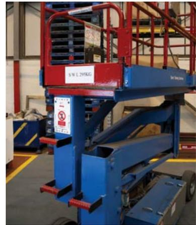
Wenn die Hubarbeitsbühne nicht sicher verwendet werden kann, wird das MEWP Tag-Einsteckschild aus dem Halter entfernt und dem Schichtführer übergeben. Der Hinweis „Nicht verwenden, bis die tägliche Überprüfung durchgeführt wurde“ mit einem Verbotssymbol ist deutlich sichtbar.
