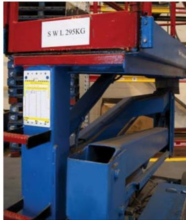
Die durchgeführte Prüfung wird mit der Unterschrift des Bedieners und dem Datum auf dem MEWP Tag-Einsteckschild vermerkt. Wenn die Hubarbeitsbühne sicher verwendet werden kann, wird das MEWP Tag-Einsteckschild in den MEWP Tag-Halter gesteckt, sodass die Details der täglichen Prüfungen und der letzte Prüftermin sofort deutlich sichtbar sind.
