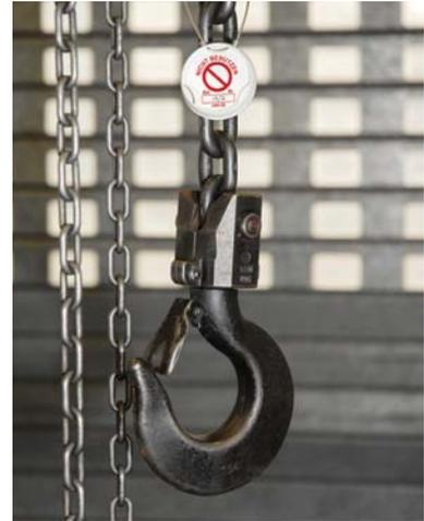
Wenn ein Gerät die Prüfung oder Inspektion nicht besteht, wird das Unitag-Einsteckschild aus dem Halter entfernt, der daraufhin sofort wieder das Verbotssymbol mit dem Hinweis „Nicht verwenden“ anzeigt.
