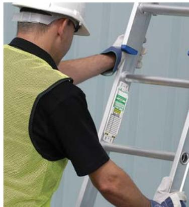
Auf der Rückseite des Laddertag-Einsteckschildes befindet sich eine übersichtliche Checkliste zur Prüfung vor der Benutzung. Nach der Prüfung der Leiter werden die Einzelheiten auf dem Laddertag-Einsteckschild vermerkt (Referenznummer der Leiter, Leiterklasse, Belastbarkeit/Verwendungszweck, nächster fälliger Inspektionstermin). Wenn die Prüfung ergeben hat, dass die Leiter sicher verwendet werden kann, wird das Laddertag-Einsteckschild in den Halter gesteckt.
