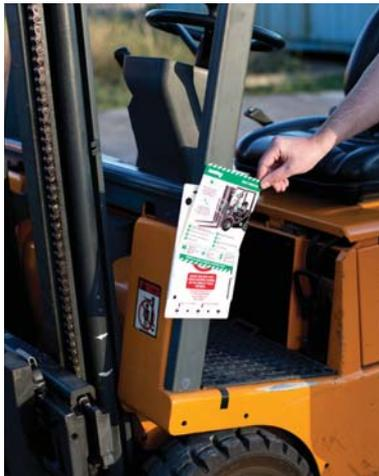
Der Forklifttag-Halter wird mit Kabelbindern oder Klebstoff in der Kabine des Gabelstaplers an einer Stelle angebracht, an der er deutlich sichtbar ist, die Bediener aber nicht stört. Vor Schichtbeginn führt der Bediener die Prüfungen durch, die auf der Checkliste auf dem Forklifttag-Einsteckschild angegeben sind.
