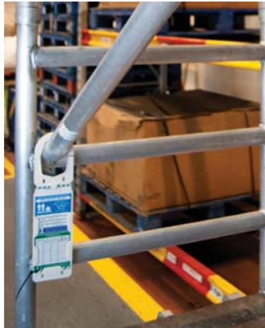
Der mobile Turm oder Mast wird von einer qualifizierten Person geprüft. Die Einzelheiten zum Aufbau und Standort des Turms oder Masts werden auf dem Tower Tag-Einsteckschild vermerkt. Wenn der Turm oder Mast sicher verwendet werden kann, wird das Tower Tag-Einsteckschild mit Datum und Unterschrift versehen und in den Tower Tag-Halter gesteckt.
