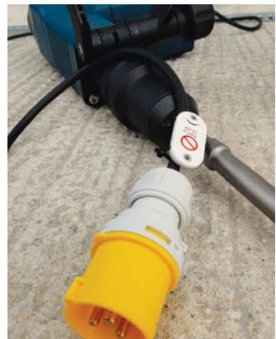
Wenn ein Gerät die Prüfung nicht besteht, wird das Nanotag-Einsteckschild aus dem Halter entfernt, der daraufhin sofort wieder den Verbotshinweis anzeigt.
