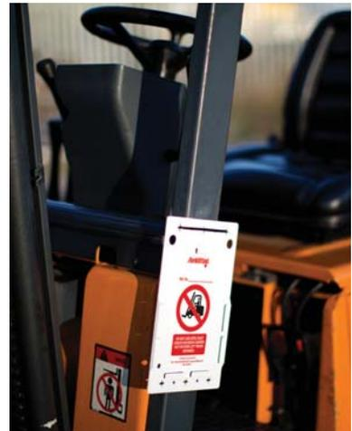
Wenn der Gabelstapler nicht sicher verwendet werden kann, wird das Forklifttag-Einsteckschild aus dem Halter entfernt und dem Schichtführer übergeben. Der Hinweis „NICHT BENUTZEN, BEVOR TÄGLICHE PRÜFUNG ODER REPARATUR DES FLURFÖRDERZEUGES ERFOLGT IST“ mit einem Verbotssymbol ist deutlich sichtbar.
