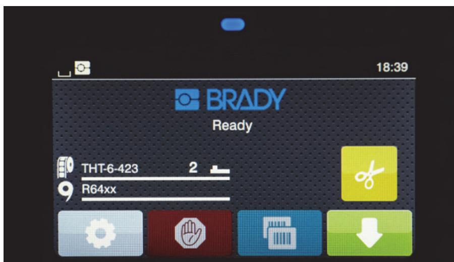
Das Touchscreen-Display wird per Fingereingabe bedient. Um ein Menü zu öffnen oder ein Menüelement auszuwählen, berühren Sie das entsprechende Symbol leicht mit dem Finger. Zum Navigieren der Listen schieben Sie den Finger auf dem Display nach oben oder unten.
