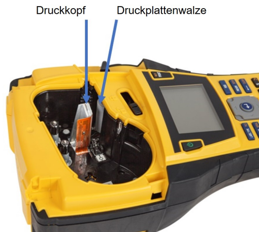
Abbildung39 • Druckkopf und Walzenrolle im Kassettengehäuse.
